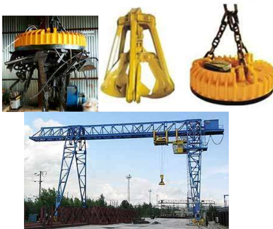
Фото 7. Работа подъемных кранов с электромагнитами.
