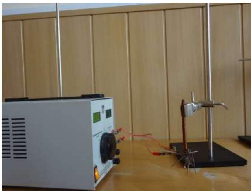
Фото. 2. Электромагнит с длинным стержнем, диаметр d = 5 мм.
