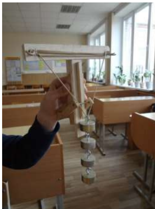
Фото 5. Сила упругости резинки арбалета F_{\text{упр}} = 4 \text{ Н} .
