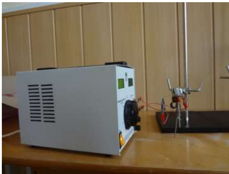
Фото. 1. Электромагнит с коротким стержнем с большим количеством витков, диаметр d = 6 мм.
