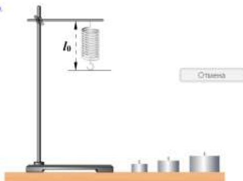
Модель 3.40. Опыт по установлению зависимости силы упругости от деформации
